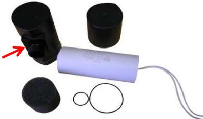
Kondensator mit Kondensatorrohr,
